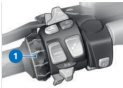
Si está acoplado un casco de conductor con un sistema de comunicación BMW Motorrad con estándar de radioemisión Bluetooth 2.0:
