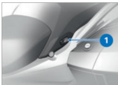
• Seleccionar el nivel de calefacción deseado con el interruptor **1**.
